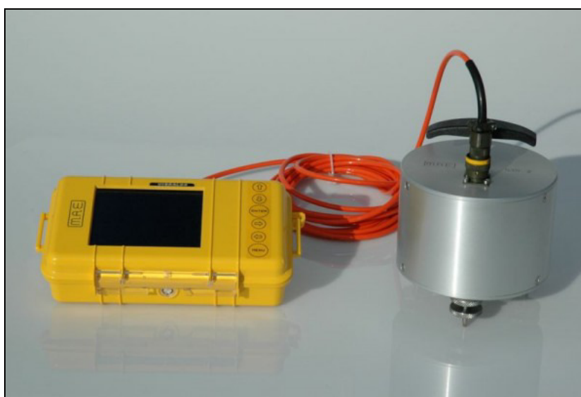
Figura 2 – Sismografo Vibralog e Terna geofonica
