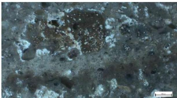
Campione C5 - in sezione lucida, luce riflessa, ingrandimento 25x (scala 500  $\mu\text{m}$ ). Distribuzione dell'aggregato all'interno della matrice del campione. Si osservano numerosi frammenti lavici e altri granuli di origine vulcanica.
