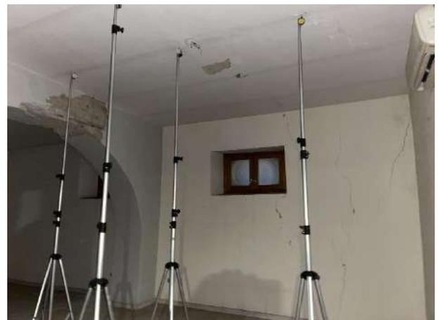
**Figura 10- Prova di carico**
