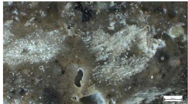
Campione C2 - in sezione lucida, luce riflessa, ingrandimento 25x (scala 500  $\mu\text{m}$ ). Pomici e lapilli all'interno della matrice dell'intonaco.
