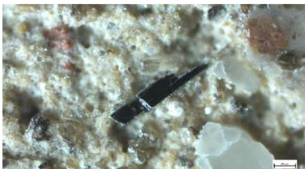
Campione C1 - in sezione lucida, luce riflessa, ingrandimento 50x (scala 200  $\mu$ m). Particolare di un cristallo di anfibolo immerso nell'arriccio. Presenta abito lamellare ed allungato, con piani di sfaldatura paralleli.
