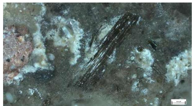
Campione C2 - in sezione lucida, luce riflessa, ingrandimento 50x (scala 200  $\mu\text{m}$ ). Granulo di composizione femica, presumibilmente un anfibolo, immerso nella matrice dell'arriccio.
