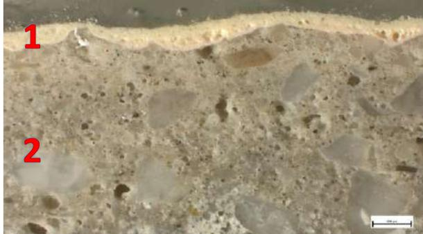
Campione C4 - in sezione lucida, luce riflessa, ingrandimento 25x (scala 500  $\mu\text{m}$ ). Stratigrafia dell'intonaco costituita dallo strato di tinteggio superficiale di colore rosato (1) e lo strato di intonachino (2), con inerti composti da granuli carbonatici.
