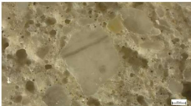
Campione C4 - in sezione lucida, luce riflessa, ingrandimento 50x (scala 200  $\mu\text{m}$ ). Particolare di un granulo carbonatico con tipiche venature scure dovute a ricristallizzazione del carbonato di calcio.
