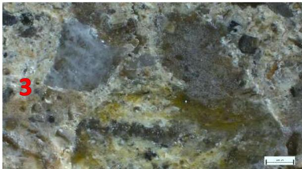
Campione C3 - in sezione lucida, luce riflessa, ingrandimento 25x (scala 500  $\mu\text{m}$ ). Strato di arriccio (3) e distribuzione dell'aggregato nella matrice. Sono presenti granuli carbonatici e minerali di origine vulcanica.
