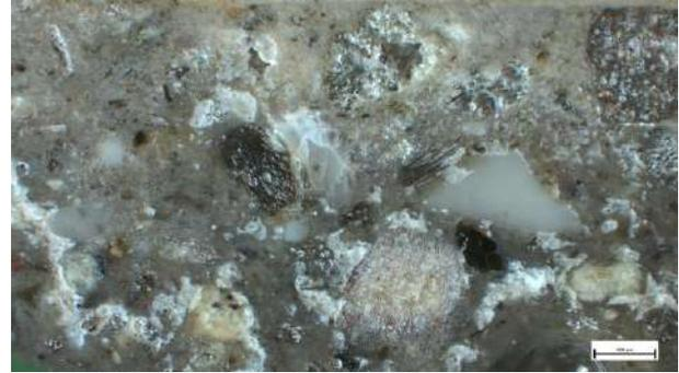
Campione C2 - in sezione lucida, luce riflessa, ingrandimento 25x (scala 500  $\mu\text{m}$ ). Distribuzione dell'aggregato nell'intonaco: sono visibili i frammenti vulcanici quali pozzolana, pomici e lapilli. Si notano, inoltre, minerali femici e sporadici granuli carbonatici.
