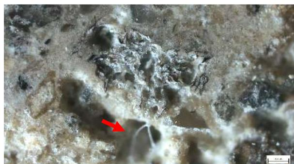
Campione C1 - in sezione lucida, luce riflessa, ingrandimento 50x (scala 200  $\mu$ m). Scoria vulcanica molto porosa e con morfologia scheletrica immersa nell'arriccio. Sono presenti, inoltre, alcune fibre immerse nella matrice (indicate dalla freccia).
