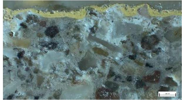
Campione C3 - in sezione lucida, luce riflessa, ingrandimento 25x (scala 500  $\mu\text{m}$ ). Distribuzione dell'aggregato nello strato di intonachino, composto da granuli carbonatici e minerali di origine vulcanica.
