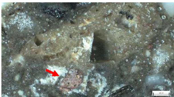
Campione C2 - in sezione lucida, luce riflessa, ingrandimento 25x (scala 500  $\mu\text{m}$ ). Particolare di un granulo di quarzo immerso nella matrice dell'intonaco. si osserva, inoltre, un frammento di laterizio frantumato (indicato dalla freccia).
