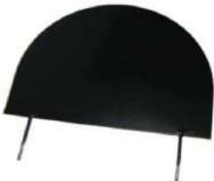
Ogni martinetto è caratterizzato da un coefficiente di taratura (K<sub>m</sub>) che tiene conto della riduzione della sezione di spinta del martinetto per effetto della rigidità di bordo dello stesso. Tutti i martinetti utilizzati nelle prove sono nuovi e certificati.
