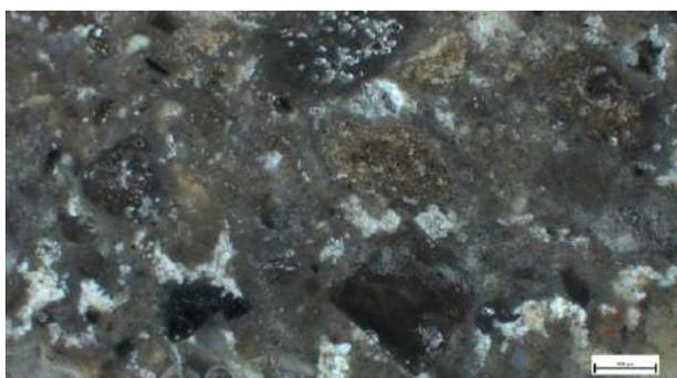
Campione C5 - in sezione lucida, luce riflessa, ingrandimento 25x (scala 500  $\mu\text{m}$ ). Distribuzione dell'aggregato all'interno della matrice del campione. Si osservano cristalli di quarzo, frammenti lavici e altri granuli di origine vulcanica.
