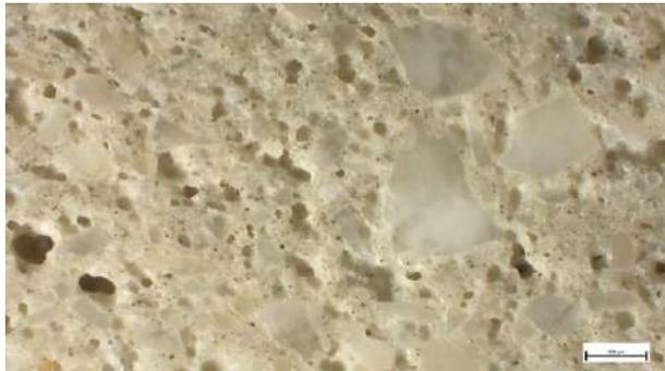
Campione C4 - in sezione lucida, luce riflessa, ingrandimento 25x (scala 500  $\mu\text{m}$ ). Distribuzione dell'aggregato all'interno della matrice dell'arriccio. Sono visibili i granuli carbonatici, moderatamente classati, ed una discreta quantità di piccoli grani di colore scuro e dimensioni micrometriche.
