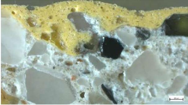
*Campione C1 - in sezione lucida, luce riflessa, ingrandimento 100x (scala 100 µm). Dettaglio della stratigrafia superficiale del campione. Si osserva, in alcuni punti, lo strato di tinteggio compenetrante nell'intonachino.*
