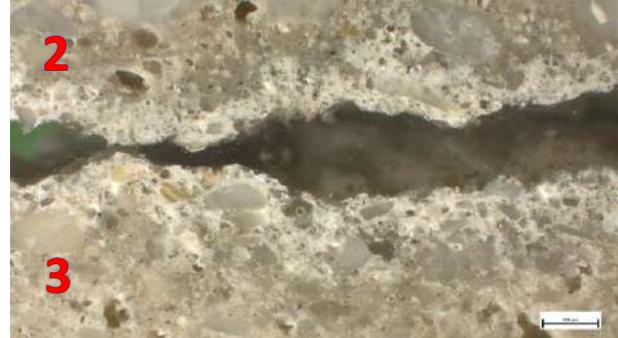
Campione C4 - in sezione lucida, luce riflessa, ingrandimento 25x (scala 500  $\mu\text{m}$ ). Stratigrafia dell'intonaco: al di sotto dell'intonachino è presente lo strato di arriccio (3), con frazione inerte composta da granuli carbonatici.
