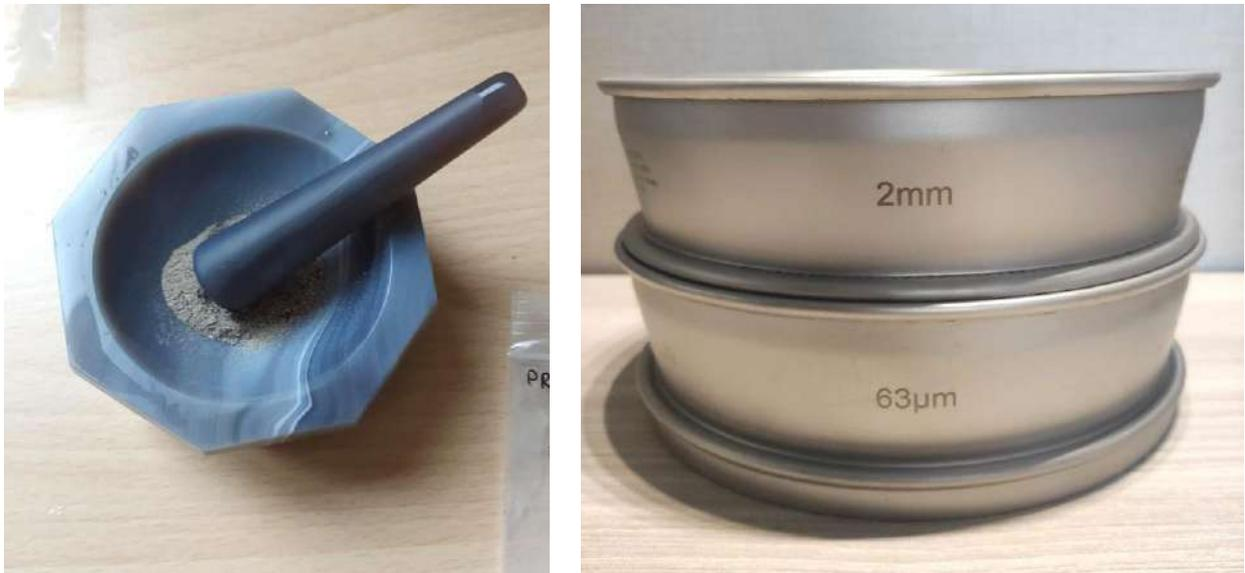
**Figura 3.** Macinatura dei campioni con mortaio ad agata e setacci utilizzati per la vagliatura della frazione più fine da sottoporre alle prove.
