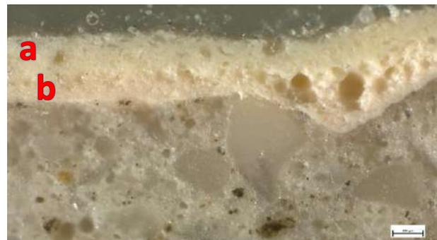
Campione C4 - in sezione lucida, luce riflessa, ingrandimento 100x (scala 100  $\mu\text{m}$ ). Dettaglio della successione stratigrafica superficiale: attraverso maggiori ingrandimenti si possono riconoscere due strati, di cui uno giallo (a) e uno rosato (b), quest'ultimo caratterizzato da elevata porosità.
