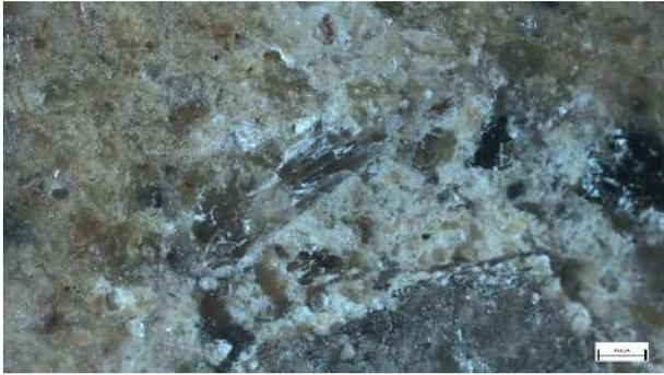
*Campione C3 - in sezione lucida, luce riflessa, ingrandimento 50x (scala 200 µm). Dettaglio di un cristallo di calcite con delle microfratture formatesi lungo i tipici piani di sfaldatura a 60°.*
