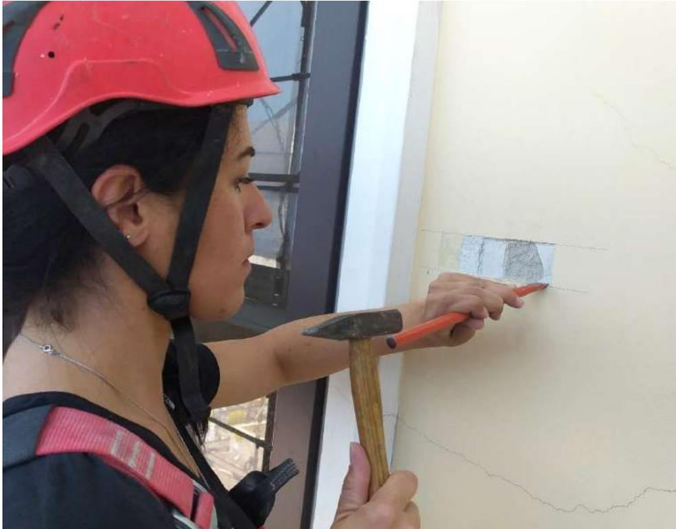
**Figura 1.** Esecuzione di un saggio stratigrafico.
