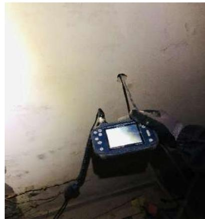
Figura 5 - Video-endoscopio flessibile Boroscope PCE-VE 200 ed esecuzione dell'indagine
