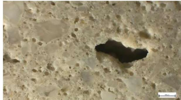
Campione C4 - in sezione lucida, luce riflessa, ingrandimento 25x (scala 500  $\mu\text{m}$ ). Un'elevata porosità caratterizza la matrice dell'intonaco (sia nell'arriccio che nell'intonachino) che, in alcuni casi, presenta dimensioni millimetriche.
