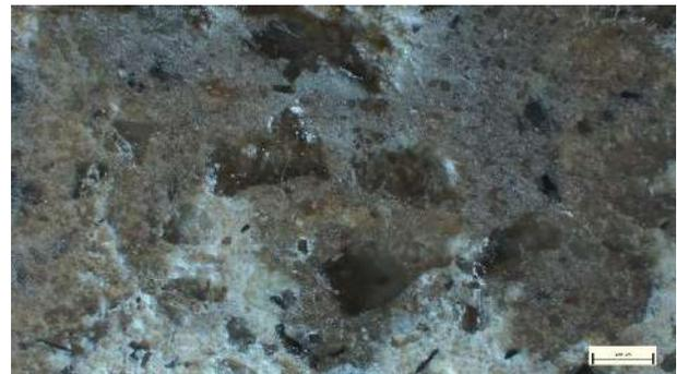
Campione C3 - in sezione lucida, luce riflessa, ingrandimento 25x (scala 500  $\mu\text{m}$ ). Cristalli di quarzo immersi nella matrice dell'arriccio.
