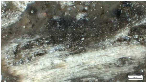
Campione C2 - in sezione lucida, luce riflessa, ingrandimento 25x (scala 500  $\mu\text{m}$ ). Dettaglio di un lapillo vulcanico con porosità direzionata, presenta dimensione pari a circa 5 mm.
