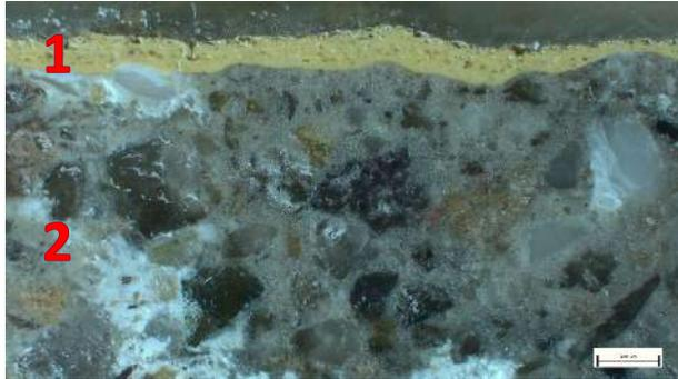
Campione C3 - in sezione lucida, luce riflessa, ingrandimento 25x (scala 500  $\mu\text{m}$ ). Stratigrafia dell'intonaco costituita dallo strato di tinteggio superficiale di colore giallo (1) e lo strato di intonachino (2) con aggregato misto composto da granuli carbonatici e minerali di origine vulcanica.
