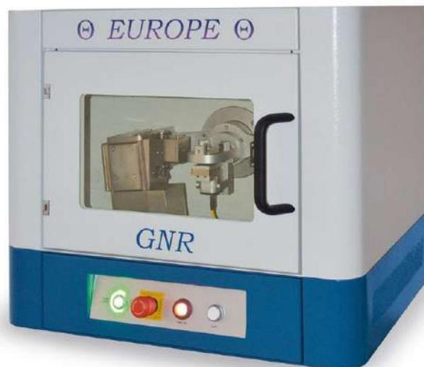
**Figura 5.** Strumento utilizzato per l'analisi in diffrattometria a raggi X: GNR Europe con geometria Theta/Theta.
