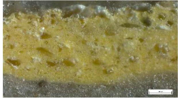
*Campione C3 - in sezione lucida, luce riflessa, ingrandimento 200x (scala 100 µm). Particolare dello strato di tinteggio superficiale, con i cristalli di quarzo immersi nella matrice.*
