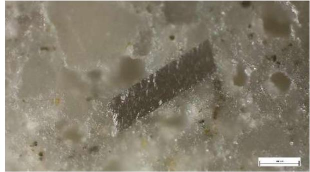
*Campione C4 - in sezione lucida, luce ultravioletta, ingrandimento 200x (scala 100 µm). Dettaglio di un cristallo di calcite che mostra un perfetto abito cristallino romboedrico.*
