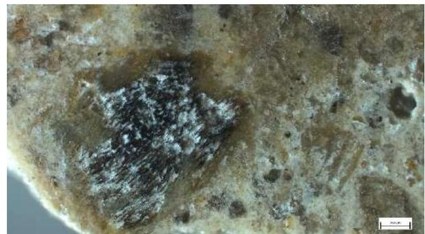
Campione C3 - in sezione lucida, luce riflessa, ingrandimento 50x (scala 200  $\mu\text{m}$ ). Particolare di un lapillo pozzolanico con orlo di reazione immerso nella matrice dell'arriccio.
