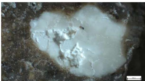
Campione C5 - in sezione lucida, luce riflessa, ingrandimento 25x (scala 500  $\mu\text{m}$ ). Particolare di un grosso grumo di calce incotta o stracotta all'interno della matrice, indice di tecnologia tradizionale di produzione della malta.
