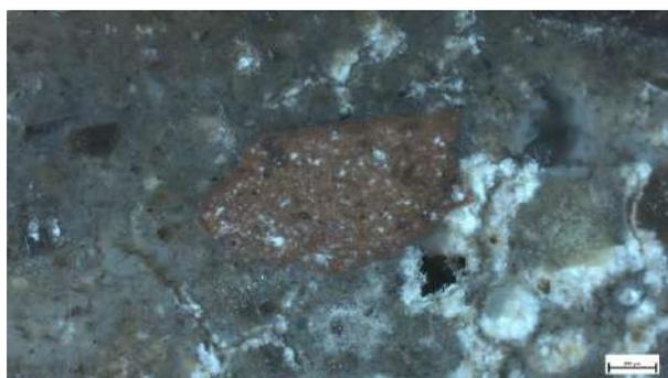
Campione C5 - in sezione lucida, luce riflessa, ingrandimento 50x (scala 200  $\mu\text{m}$ ). Particolare di un frammento di laterizio all'interno della matrice del campione.
