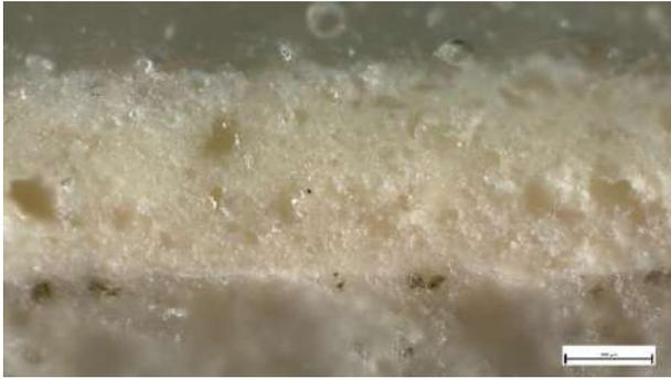
*Campione C4 - in sezione lucida, luce riflessa, ingrandimento 200x (scala 100 µm). Particolare della successione stratigrafica superficiale.*
