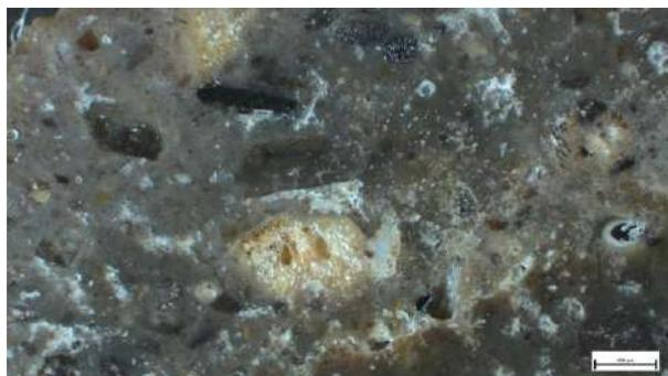
Campione C5 - in sezione lucida, luce riflessa, ingrandimento 25x (scala 500  $\mu\text{m}$ ). Un granulo composto da inclusioni cristalline (di colore giallo) e altri minerali di origine vulcanica (femici e frammenti lavici, di colore scuro).
