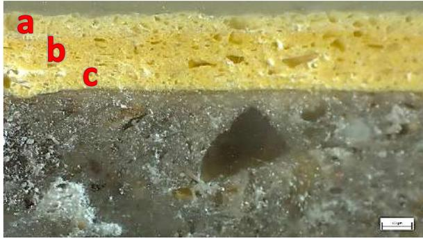
*Campione C2 - in sezione lucida, luce riflessa, ingrandimento 100x (scala 100  $\mu$ m). Ingrandimento della stratigrafia superficiale dell'intonaco, composto da una successione di strati di colore giallo, con aggregati quarzosi all'interno.*
