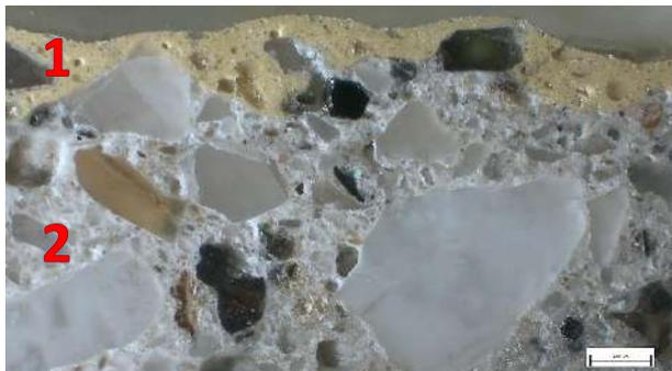
Campione C1 - in sezione lucida, luce riflessa, ingrandimento 25x (scala 500  $\mu$ m). Stratigrafia dell'intonaco costituita dallo strato di tinteggio superficiale di colore giallo (1) e lo strato di intonachino (2) con aggregato misto composto da granuli carbonatici e di origine vulcanica.
